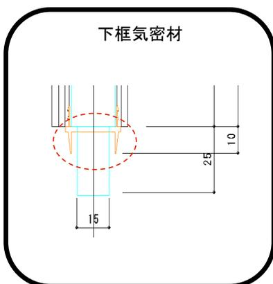
框の全周に気密材が付いているので、ホコリの侵入を抑え、冷暖房効率もアップします。
