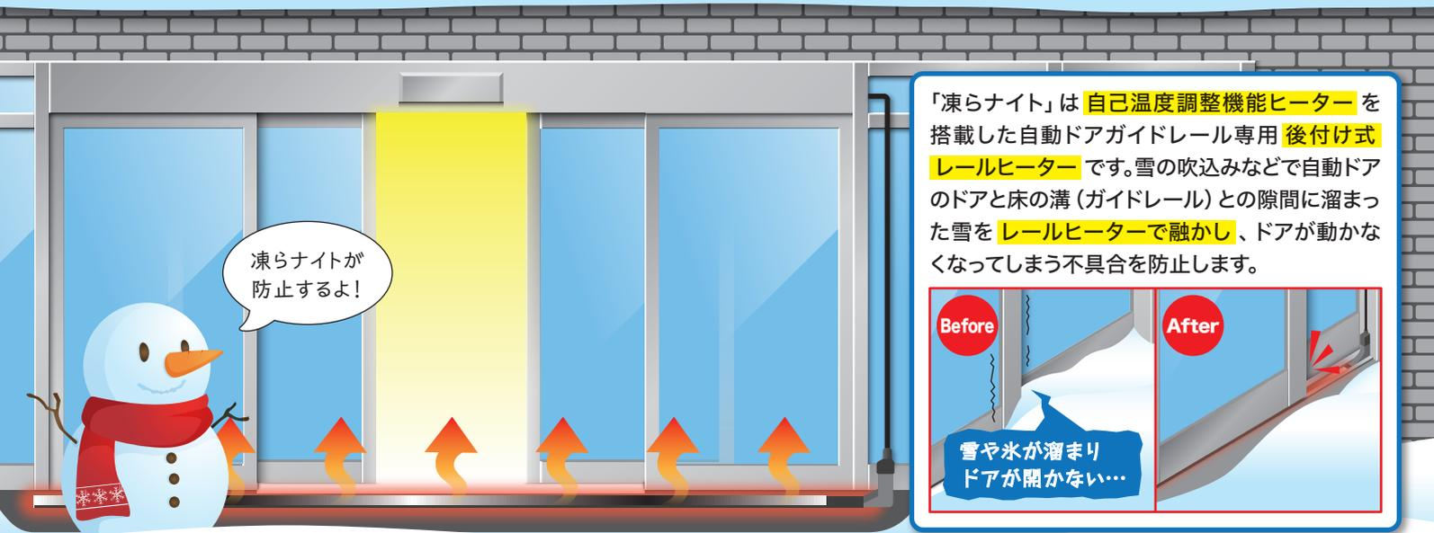
「凍らナイト」は 自己温度調整機能ヒーター を搭載した自動ドアガイドレール専用 後付け式レールヒーター です。雪の吹込みなどで自動ドアのドアと床の溝 (ガイドレール) との隙間に溜まった雪を レールヒーターで融かし、ドアが動かなくなってしまう不具合を防止します。
